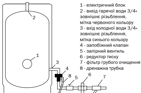
Рис.4. Схема підключення ЕВАД Steatite підлогових.
