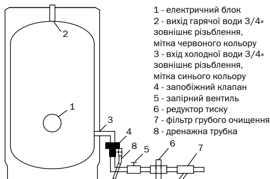
Рис. 4. Схема підключення ЕВАД Steatite підлогових.
